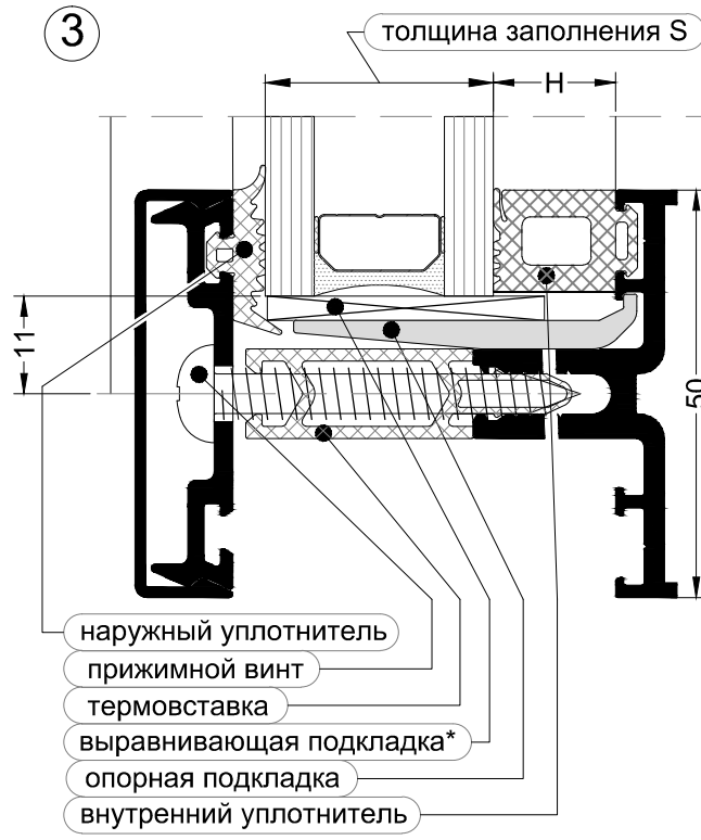
Вариант А Прижимы из профилей 90400, 90401
